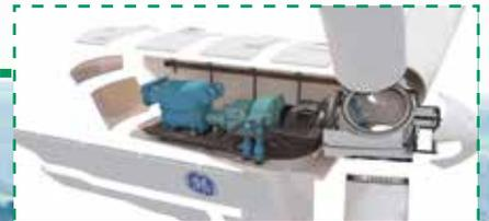
Gondel mit Getriebe, Generator und Transformator. Der Umrichter befindet sich im Turmfuß.
